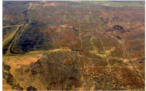
شبكة من التجارب الزلزالية المستعملة لتحديد أماكن النفط ومناطق الحفر في الكتلة A
